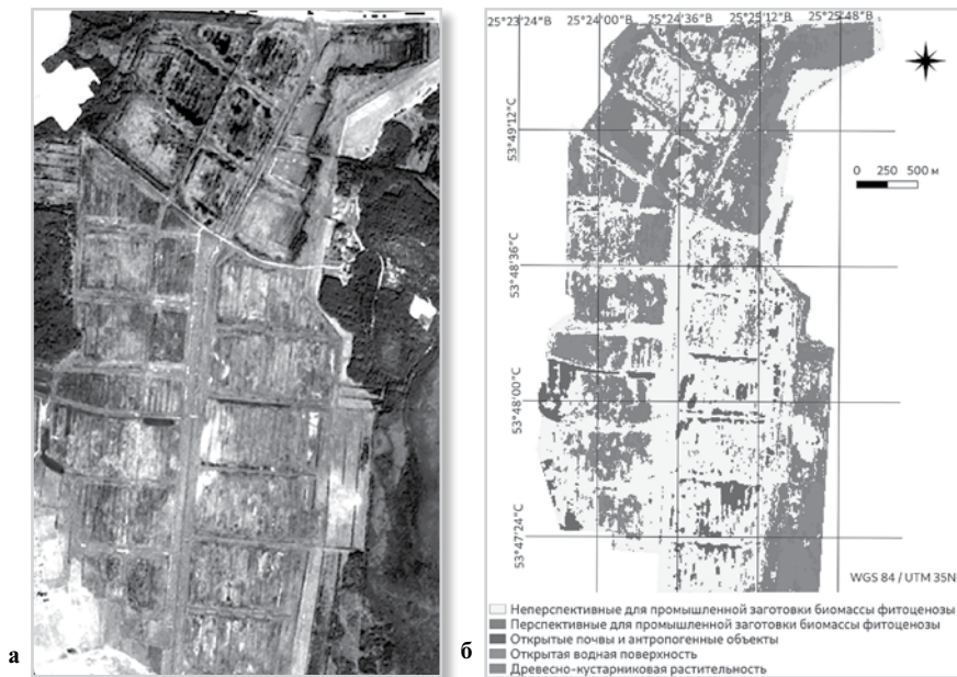
Рисунок 1 – а) фрагмент снимка Sentinel-2 юго-западной части торфяного месторождения Докудовское, RGB-визуализация; б) тематическая карта юго-западной части торфяного месторождения Докудовское по состоянию на 10.08.2018
