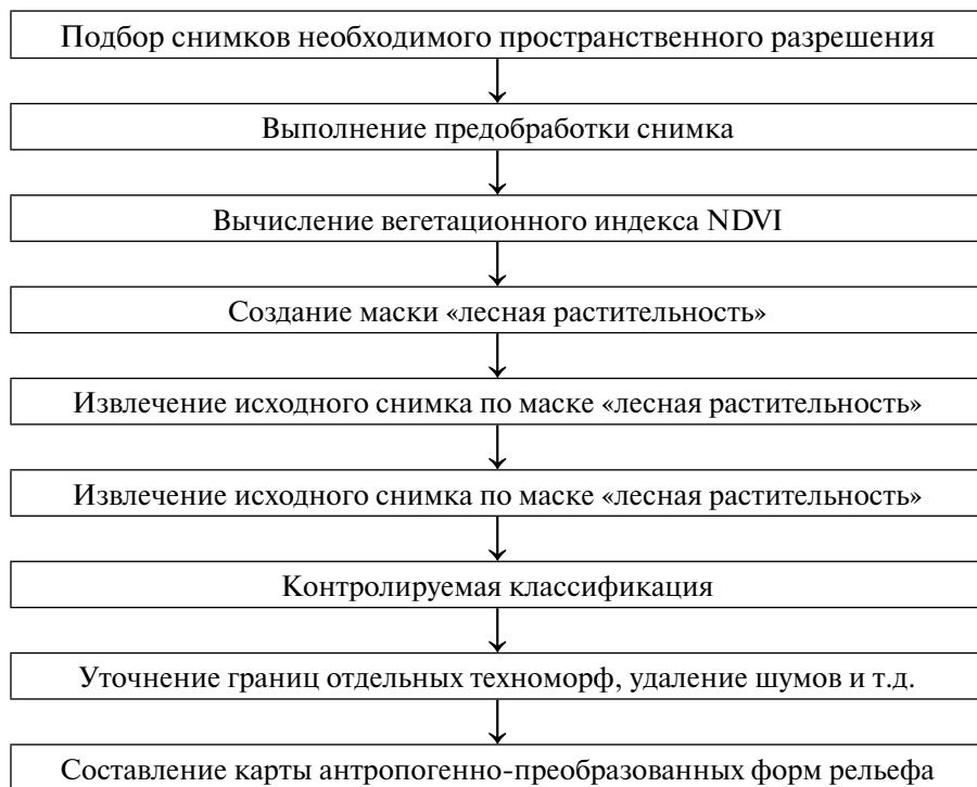
Рис. 1. Блок-схема этапов автоматизированного выявления антропогенно-преобразованных форм рельефа
