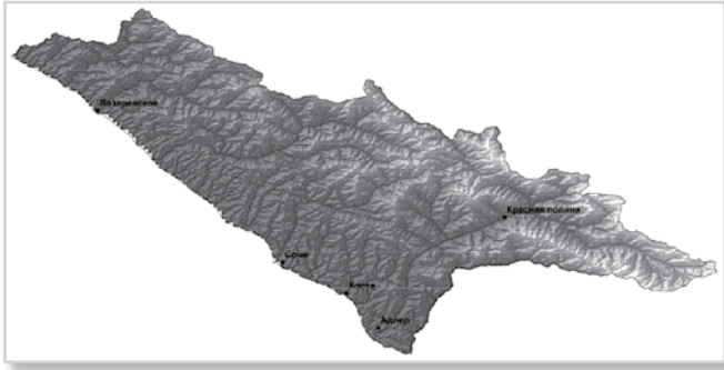
Рис. 1. Растр удалённости точек пространства от водотоков, полученный с помощью инструмента Euclidean distance (Эвклидово расстояние) в среде ArcGIS.
