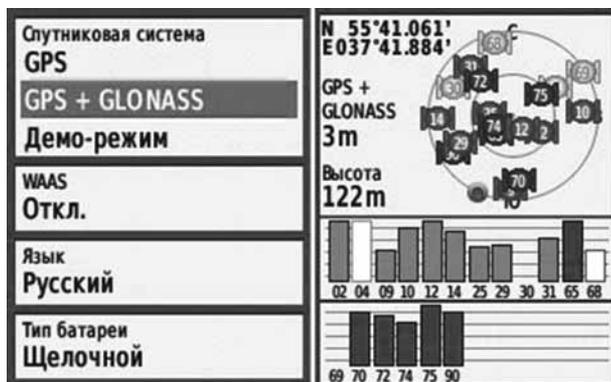
Рис. 8. Включение комбинированного режима в навигаторах GARMIN ETREX 30 и визуализация страницы СПУТНИКИ.
