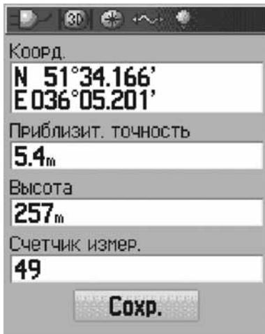
*Рис. 1. Страница вывода и информации об усреднении позиции в приборе GPSMAP 76CSx.*
