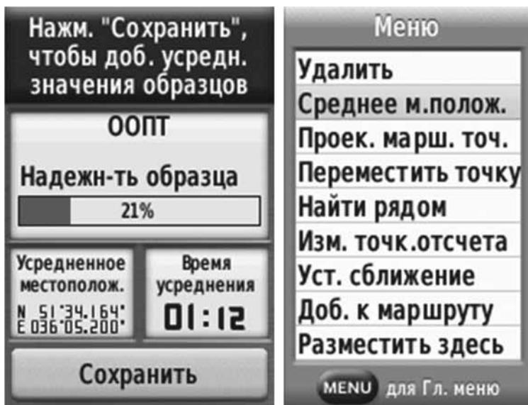
*Рис. 3-4. Включение функции постусреднения в приборах GARMIN GPSMAP 78S и OREGON 550.*
