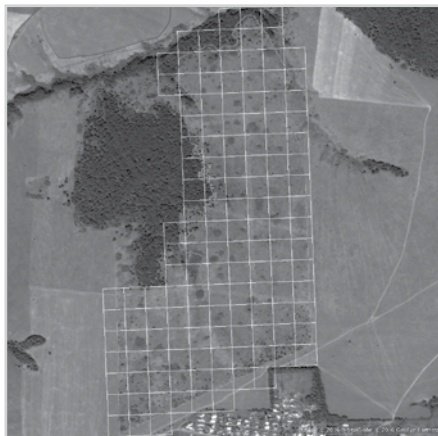
Фото 5 — Основная виртуальная сеть с размером ячейки 100 \times 100 м (1 га)
