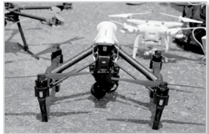
Фото 4 — БПЛА DJI Inspire-1 Pro, использованный для аэрофотосъемки участка
