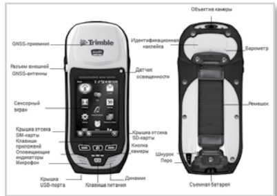
Фото 2 — Внешний вид полевого контроллера Trimble GeoExplorer 6000 GeoXH CE, использованного при картировании древесно-кустарниковой растительности
